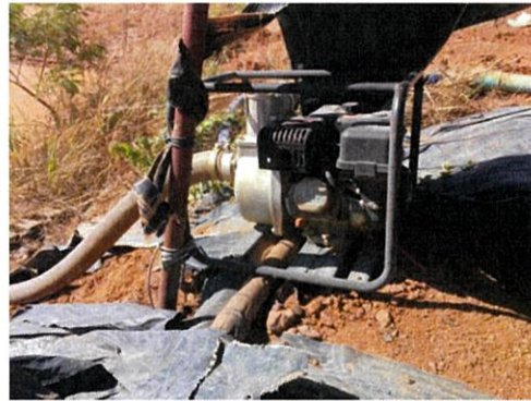
รูปที่ 2-14 บิมน้ำบริเวณบ่อรับน้ำ (Sump) ภายในพื้นที่โครงการฯ
